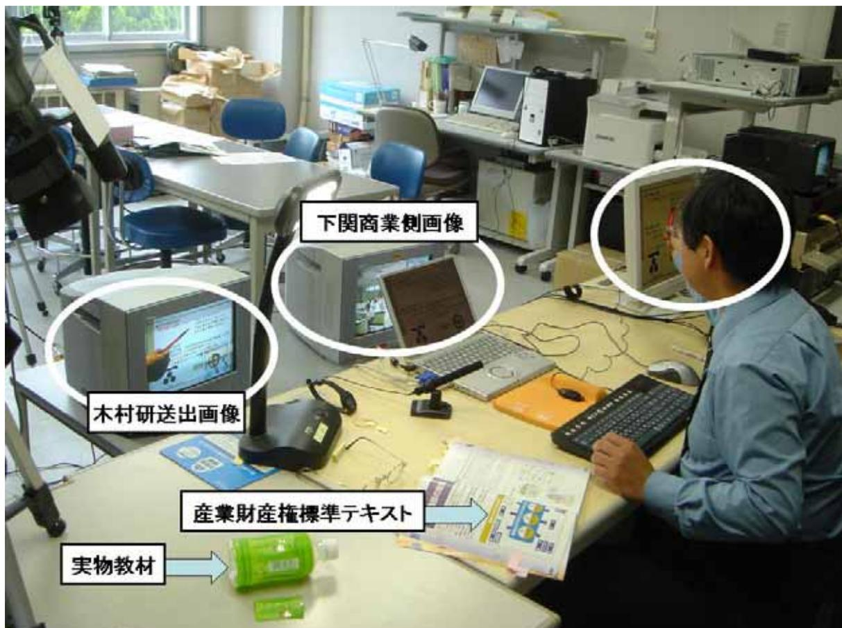
必須機材として、双方の教室に配置したmpeg2コーデック（弁当箱程度の大きさ）と通常のインターネット回線のみで双方向遠隔授業環境を再現できる。カメラ、モニター等の機材は手持ち民生用機材を転用でき、mpeg2コーデックへのケーブル接続もビデオデッキと同じ感覚でAVケーブルを接続するだけである。回線の帯域としては、上り下り各4メガ、計8メガが確保できたらmpeg2による動画交換が可能である。なお、帯域環境が悪い場合に備えて低いレートで若干画質を落とした設定も用意されている。この検証授業で利用したコーデック（NTTエレクトロニクス製 SU1000）は音声遅延時間が0.2秒であり、双方向遠隔授業で課題となる音声遅延の違和感は生まれなかった。
